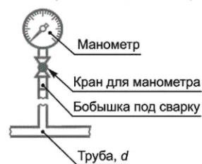
Схема установки основного манометра
